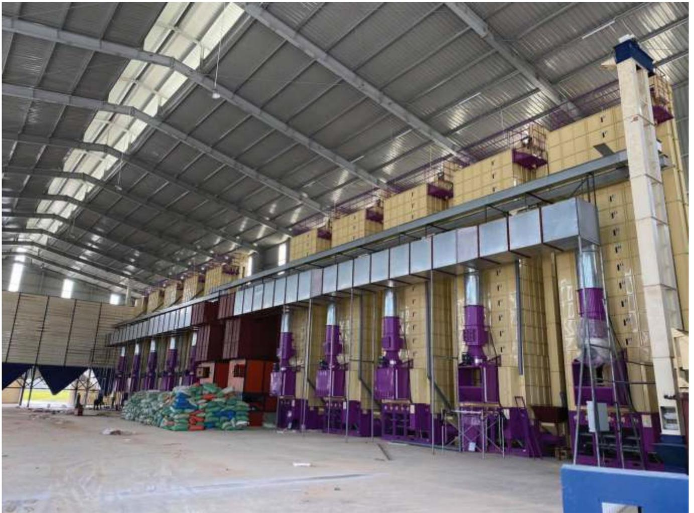
Компания гордится своей лидирующей долей на рынке Японии. Мы делаем возможной автоматическую сушку без потери качества зерна. Сушка осуществляется до заданного уровня влажности при оптимальной температуре в зависимости от температуры окружающего воздуха и объема засыпанного зерна. Благодаря стабильной сушке, обеспечивается эффективная работа на следующих этапах.
